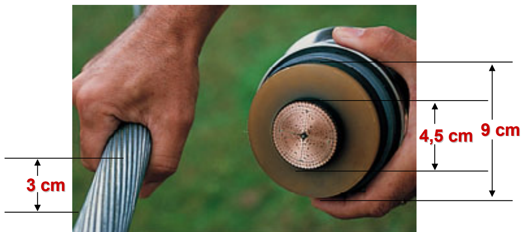
Exemple de câble électrique souterrain Comparaison avec les dimensions d'un câble aérien (à gauche)
